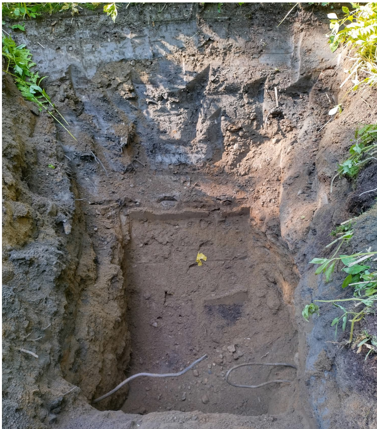
Kuvat 10–11. Kaatopaikka/jätetäyttöalue. Koekuoppa 6. Koekuopan syvyys on n. 2,5 m.
