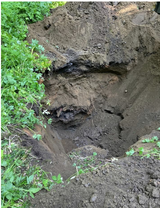
Kuvat 5–9. Kaatopaikka/jätetäyttöalue. Koekuoppa 5, jossa on runsaasti jätetäyttöä ja kaksi mustaa maakerrosta. Koekuopan syvyys on 4,8 m.
